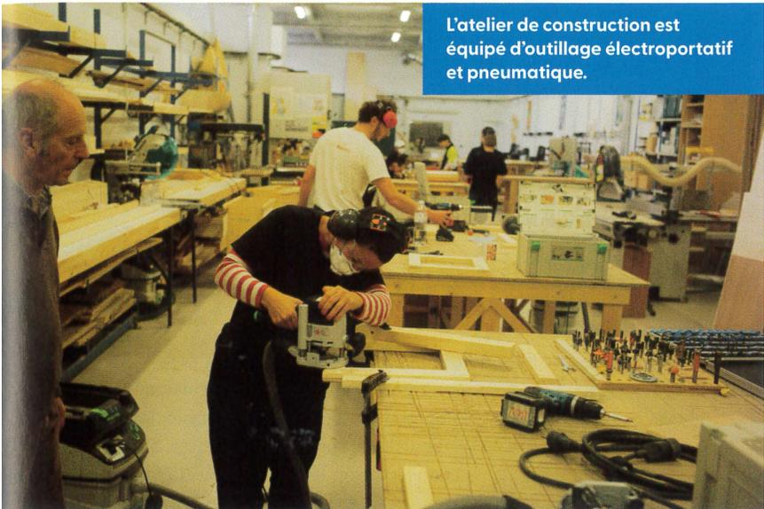
L'atelier de construction est équipé d'outillage électroportatif et pneumatique.
